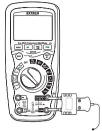
**Anmerkung:** Die Temperaturspanne der gelieferten Thermoelementprüfspitze ist -20 zu 250°C (-4 zu 482°F)
