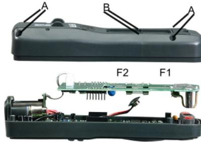
**ATTENZIONE:** Per evitare folgorazioni, non adoperare lo strumento finché il coperchio del fusibile non è al suo posto e chiuso saldamente.
